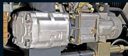
La pompe principale : 43,8 l/min (sur TG5470)
