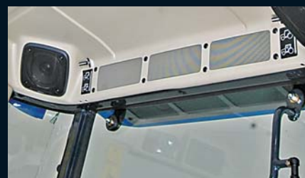
Pré-équipement autoradio et unité de filtrage de l'air de la cabine
