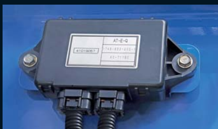
L'ECU (Electronic Command Unit) est le cerveau du système Power Shift
