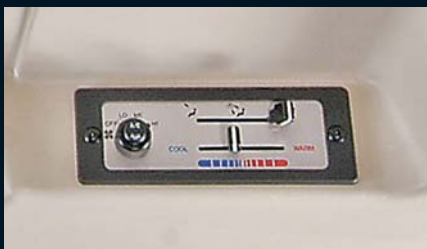
Sur le pavillon à portée de main droite : commandes chauffage et climatisation (TG5470)
