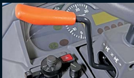
L'inverseur de marche, lui aussi à commande hydraulique pilotée électroniquement
