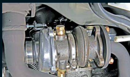
Compresseur turbo : des chevaux en plus pour TG5390
